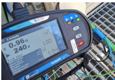
Jährliche Stichprobenkontrolle einer Steckdose im Aussenbereich. Die Renergia betreibt eine eigene Trafostation und produziert Strom. Deshalb wird sie vom ESTI wie ein EW behandelt und muss von Gesetzes wegen alle elektrischen Installationen und Anlagen nach dem Vier-Augen-Prinzip prüfen.
